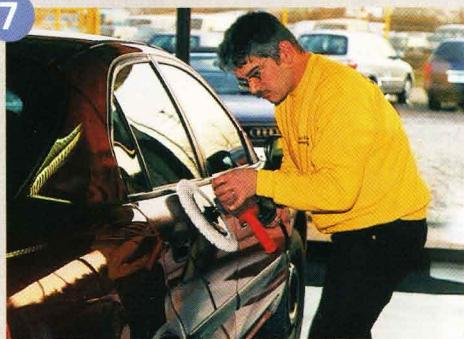
Eine Politur verleiht stumpfem Lack wieder neuen Glanz und entfernt die feinen Kratzer der Waschanlage. Je nach Aufwand ab etwa 150 Mark
