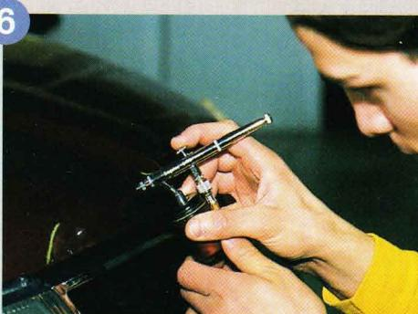
Lackschäden, Kratzer und Beulen werden ausgebessert. Die Profis mischen die Farbe für jedes Auto neu an. Kosten: pro Beule ab etwa 150 Mark
